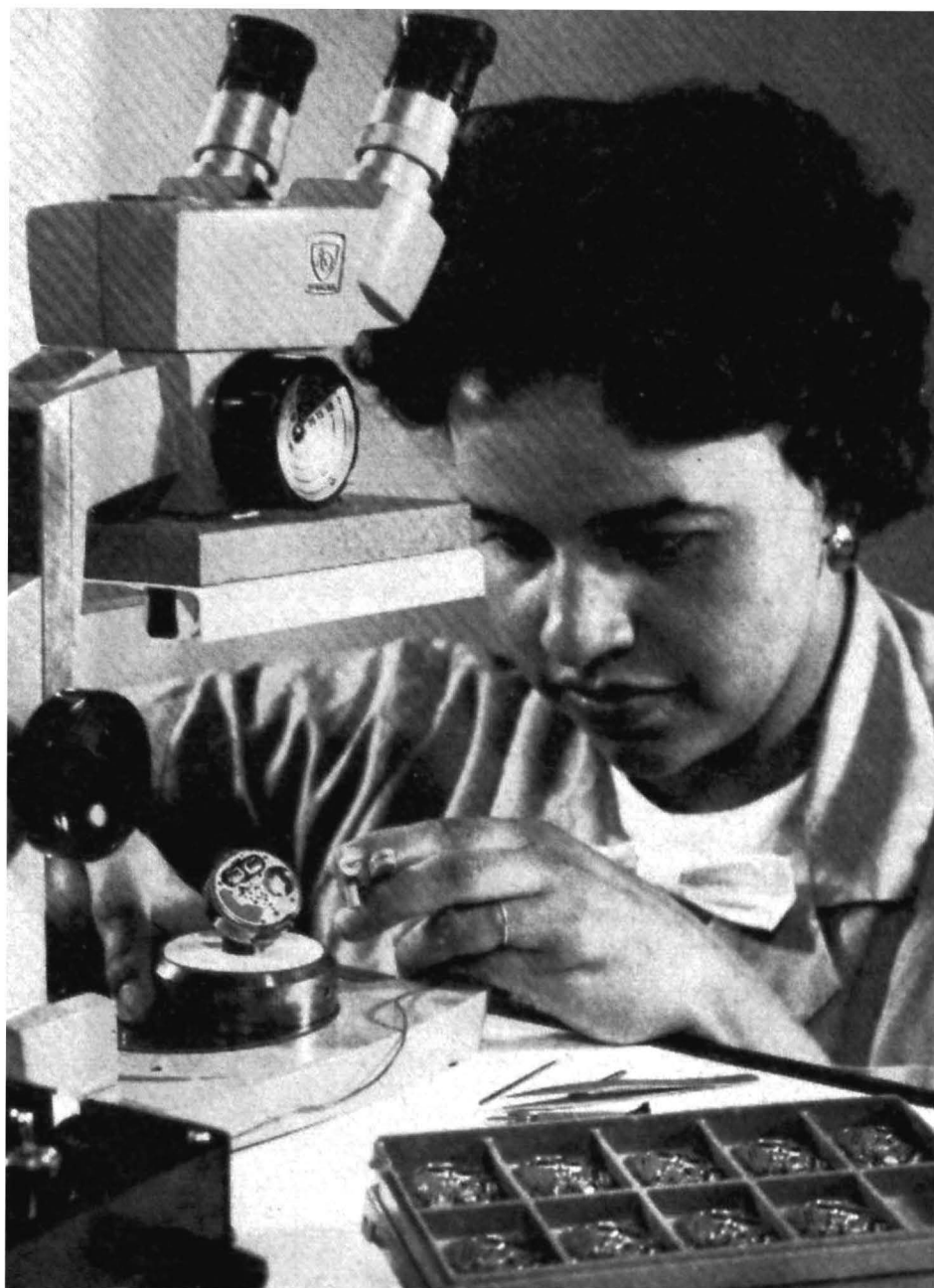
3 Montage des Accutron-Werkes.
