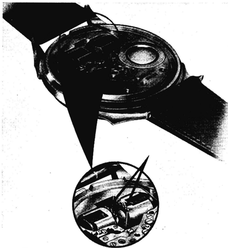
Fig. 1. Die Reguliermassen der Accutron. Fig. 1. — Les clavettes de réglage de l'Accutron.
