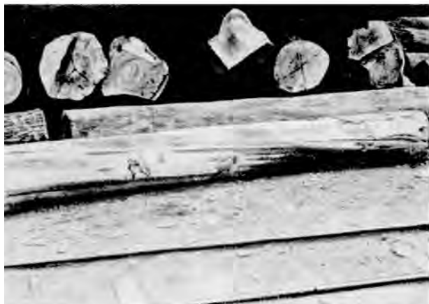
Bild 49. Starke Luftrisse an einem drehwüchsigen Stamm
