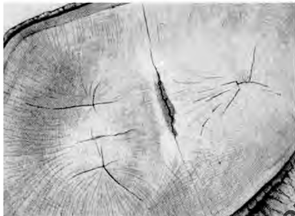
Bild 42. Eichenstamm mit drei Kernen (Drillingswuchs). Der ungleiche Wuchs verursacht starke Spannungen
