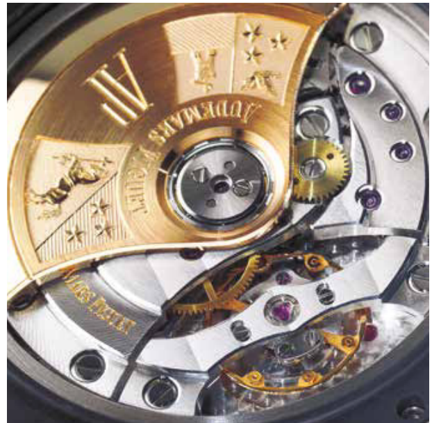
Abb. 39 Kaliber 3120, ein neues Automatikwerk, welches Tradition mit modernster Technik verbindet. Gyromax-Unruh mit 8 Masse-Lotte-Gewichten, eine symmetrische Unruh-Brücke, eine elegant gelöste Einstellung des Abfalles sowie eine ästhetische Gesamtkonstruktion belegen die hohe Innovationskraft von Audemars Piguet.
