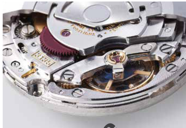
Abb. 13 Marktführer Rolex mit seinem exzellenten Automatikkaliber 3135. Die mit gebläuter Breguet-Spirale arbeitende Unruh wird in einer in der Höhe einstellbaren Brücke gelagert. Am Unruhreif ganz vorne ist noch die rändelförmige Feinstellung »Microstella« zu sehen.
