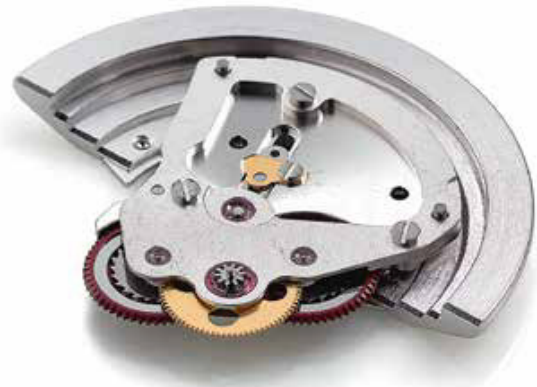
Abb. 11 Ein höchst seltenes Bild: Die ausgebaute Automatikbrücke mit Rotor des Rolex-Kalibers 3135, auf den Kopf gestellt. Deutlich erkennt man die rot- und goldfarben-eloxierten Zahnräder.
