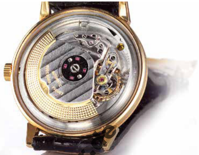
Abb. 35 Kaliber K 2072 mit Schraubennurh und Feinstellung über Mikrometerschraube und Schwanenhalsfeder. Mit der Integration der Datumsanzeige stieg die Bauhöhe des Werkes von 5,50 auf 6,30 mm.
