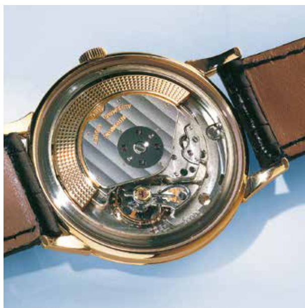
Abb. 33 Kaliber K 2070 mit 29 Steinen. Der Rotor wird mit vier Rubinwalzen geführt, die Rotorträgerplatte ist mit Genfer Streifenschliff verziert. Im Vordergrund die Reglage mit Schraubenunruh, Mikrometerschraube und Schwanenhalsfeder.
