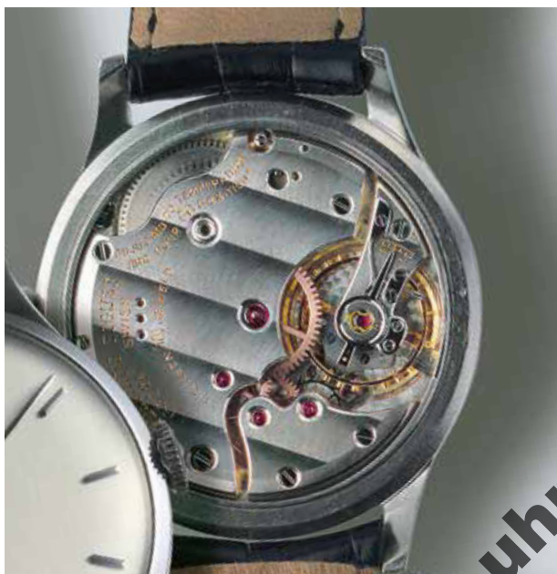
Abb. 28 Valjoux-Kaliber 13 ''' VZSS, welches als Rohwerk (Ebauche) von Valjoux bezogen wurde. Mit 30 mm Außendurchmesser und 4,00 mm Höhe war genug Bauvolumen für eine verlässliche Konstruktion vorhanden.
