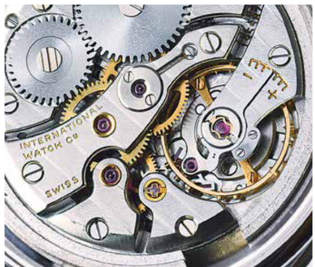
Abb. 14 Ausschnitt eines IWC Handaufzugwerks Kaliber C. 89 in bisher nicht bekannter Sonderausführung, verbaut in einem Modell Yacht Club. Dieses Werk entpuppte sich wegen seines besonders hohen technischen Niveaus als Sensation. Einzelheiten hierzu sind im Kapitel 5. IWC nachzulesen (Werk-Nr. 1.955.875).
