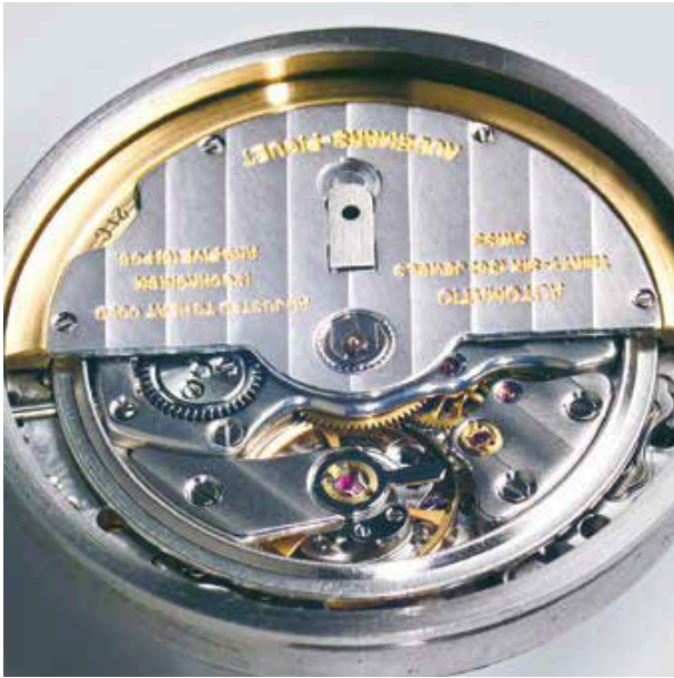
Abb. 37 Kaliber K 2121. Berylliumring, Rotorträger und Schwunggewicht sind gemeinsam vierfach verschraubt. Der Berylliumring läuft auf vier vertikal gelagerten Rubinrollen. Der Rotor wird zentrisch von der Innenbohrung des mit dem Rotor vernieteten Triebes geführt, dessen Achse aus einem gut dimensionierten Beryllium-Hohlflansch besteht. Im Vordergrund die dreiskenklige Unruh mit verstellbarem Spiralklotzenträger und Rücker ohne Feinstellung.
