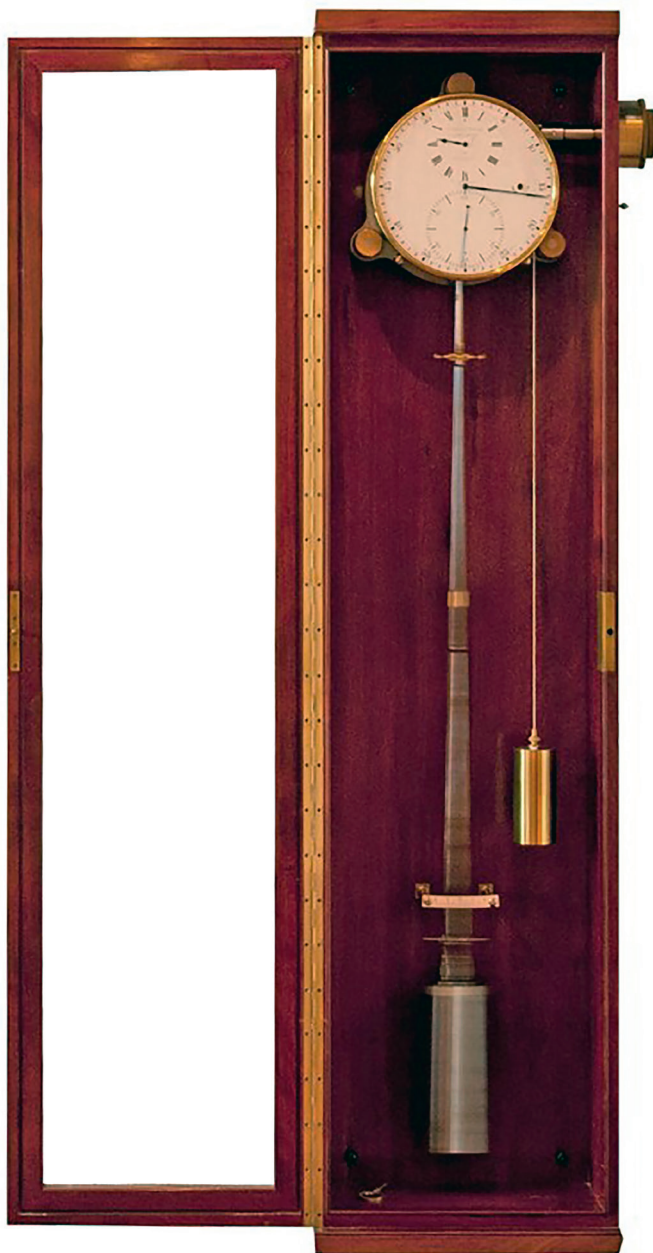
Figure 19 : Pendule de précision sans nom du Lycée Jules Haag, vue générale, porte ouverte, bouton rotatif en haut à droite pour actionner le treuil du curseur de Huygens.
