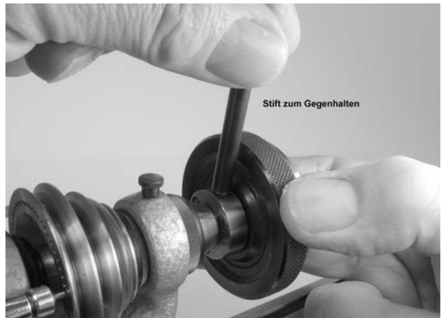
Abb. 4.1.38 a Festhalten des Futters beim Spannen mit dem Stift
