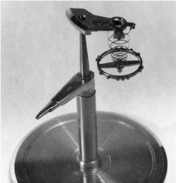
Abb. 71 Auf dem Dorn lässt sich der Unruhkloben praktisch aufhängen, ...
