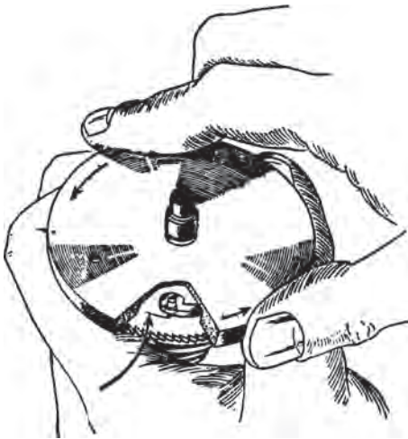
Abb. 185: Markieren der Bohrung für den Federstift im Gegengesperrrad.
